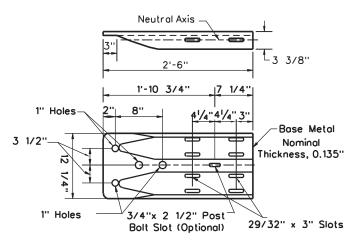
GUARDRAIL END SHOE DETAIL
